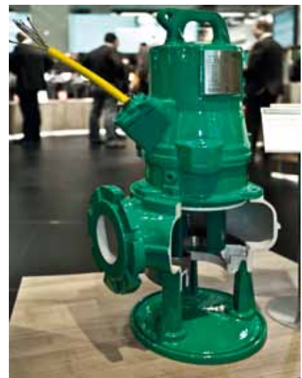
▲ Mit SOLID ausgestattete Abwasserpumpen der Baureihe Wilo EMU FA sparen bis zu 20 % der Stromkosten.
